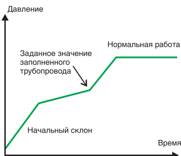
Режим заполнения трубопровода для предотвращения гидравлического удара
